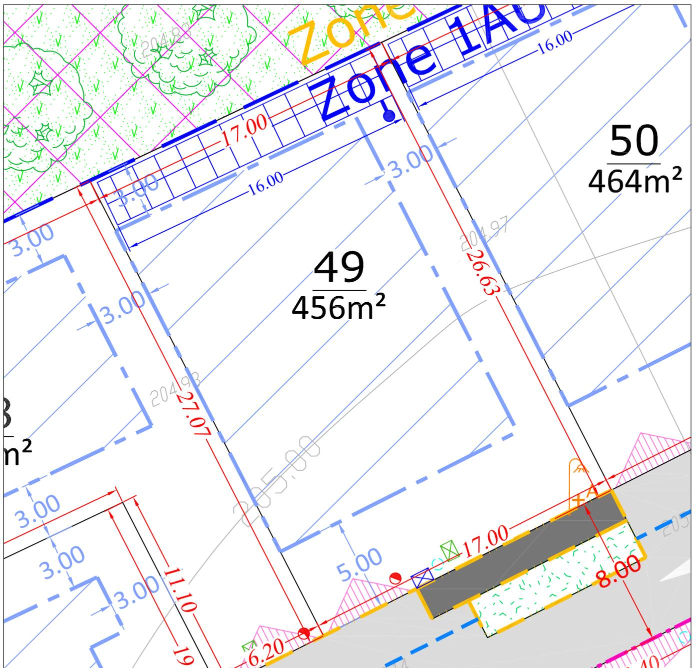
Dimensions du dispositif d'infiltration-rétention des eaux pluviales à la parcelle : 16.00m x 2.50m x 0.60m
