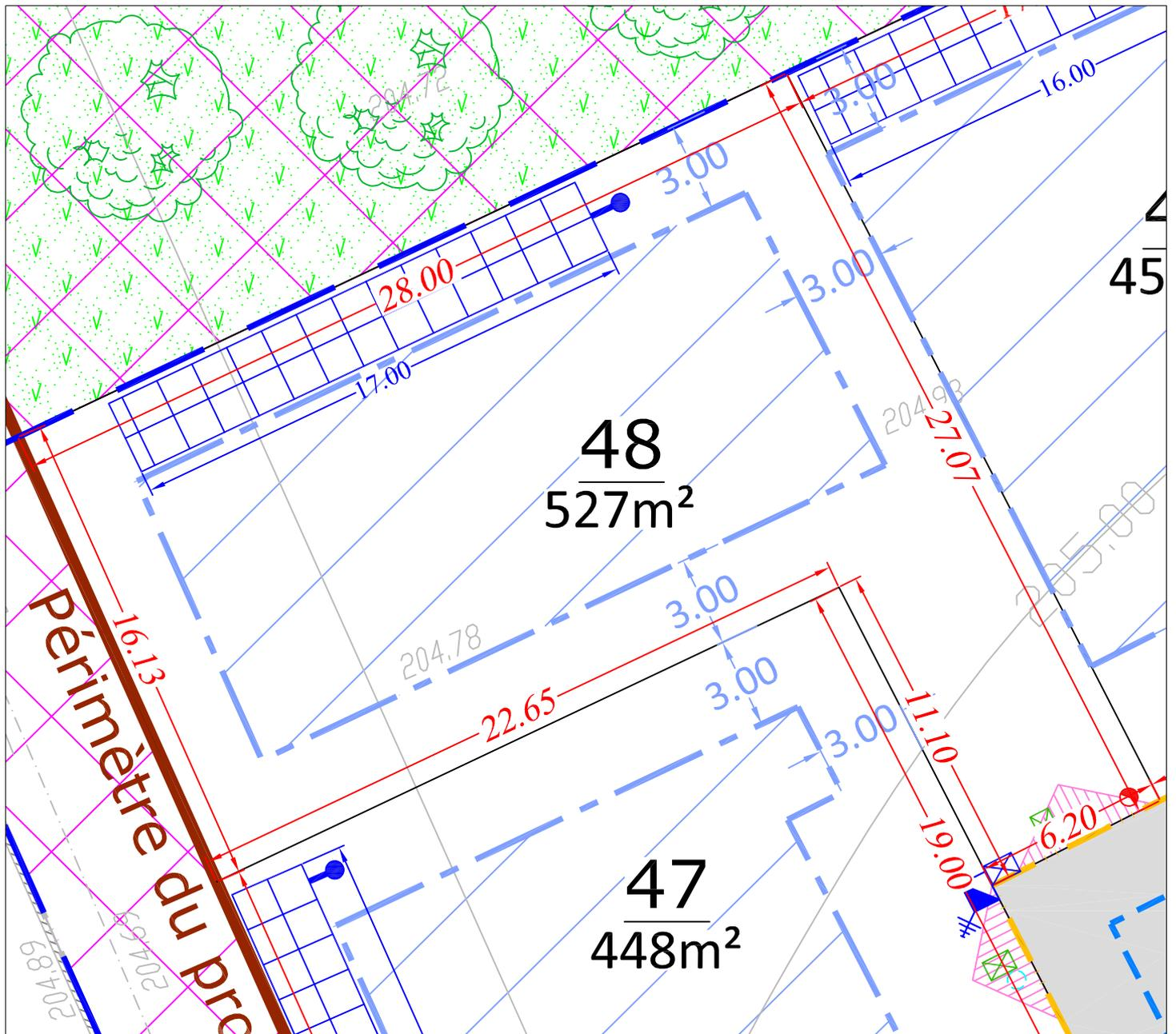
Dimensions du dispositif d'infiltration-rétention des eaux pluviales à la parcelle : 17.00m x 2.50m x 0.60m
