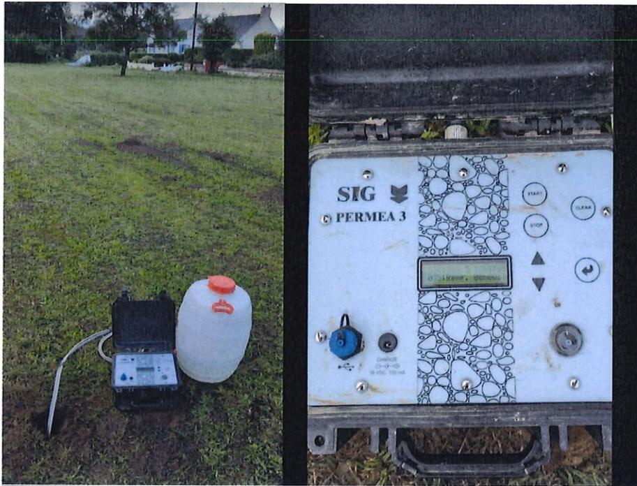
*Position du test d'infiltration et résultat*
