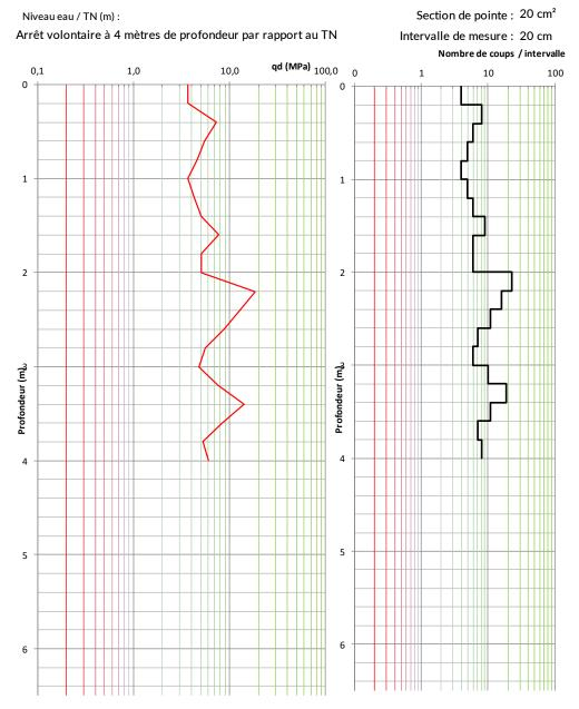
Norme de l'essai : NF EN ISO 22476-2 de Juillet 2005
