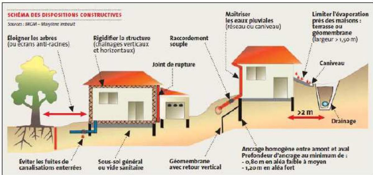
Illustration 4 : Schéma synthétique des dispositions constructives (www.georisques.gouv.fr)
